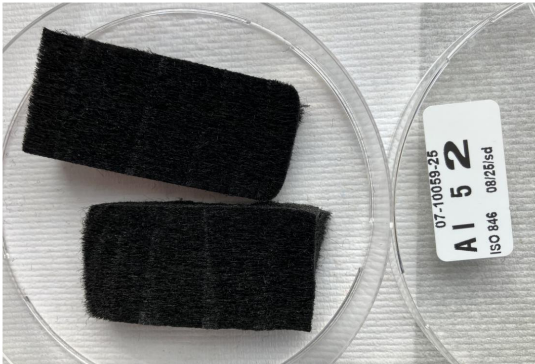
Abbildung 2: Prüfkörper des inokulierten Materials aPerf® board, schwarz (07-10059-25-2) (Gruppe I, beimpft) am Ende der Prüfung nach Verfahren A, DIN EN ISO 846:2020. Repräsentative Abbildung, Bewertung: 0.
